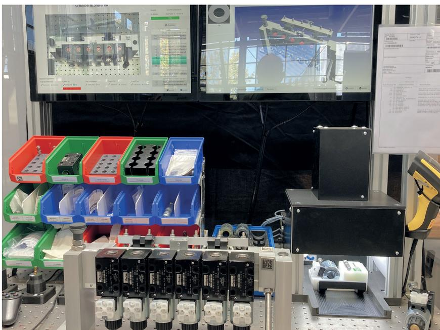
Bild 1. An einem Demonstrator-Arbeitsplatz zur Ventilmontage werden flexible Technologien für die Montageassistenz und -prüfung erprobt. © Fraunhofer IFF
